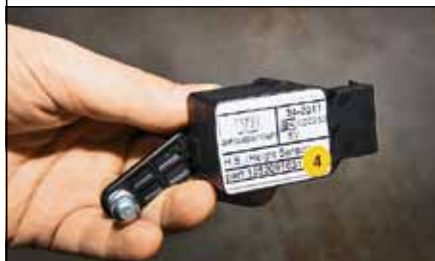
Полной пневматике необходимы датчики уровня пола
