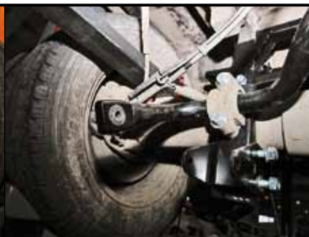
На новый меняют и стабилизатор поперечной устойчивости
