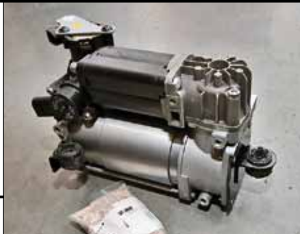
Влагоулавливающие гранулы размещены внутри корпуса компрессора
