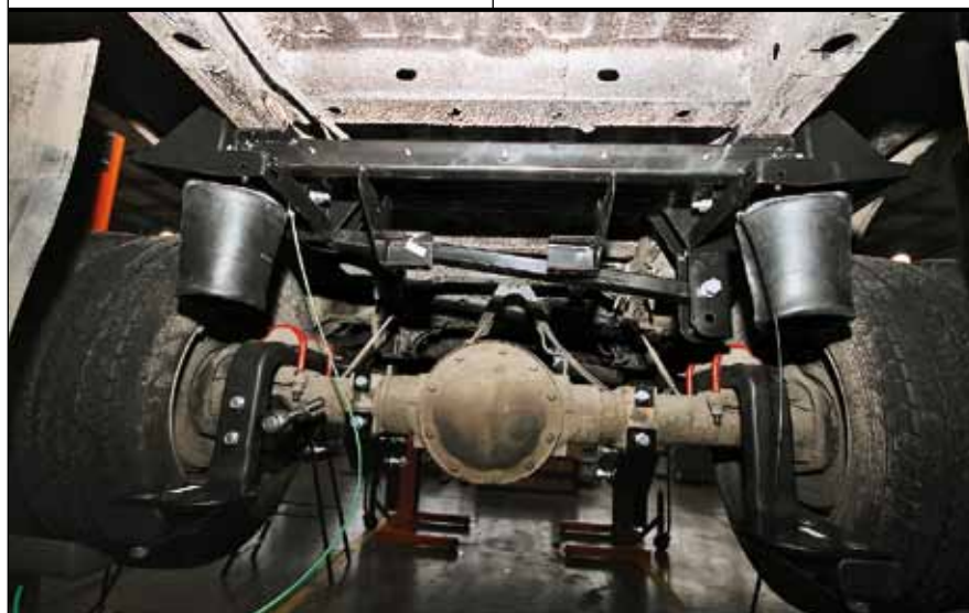
Полная пневматика не требует к себе внимания водителя, давление в баллонах регулирует электронный блок управления в автоматическом режиме
