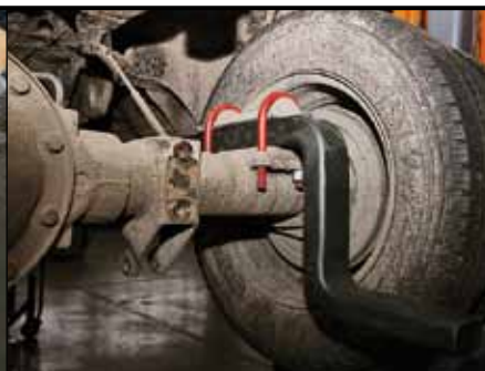
Рессоры штатной подвески заменяют менее громоздкими полурессорами
