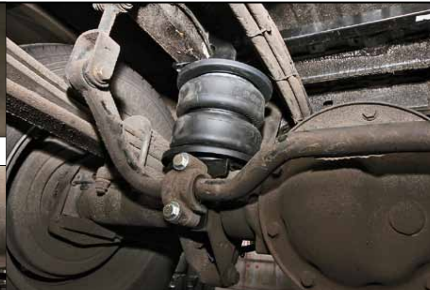
При полной загрузке машины со вспомогательной пневматикой необходима подкачка баллонов, если же кузов пустой – стравливание воздуха из них
