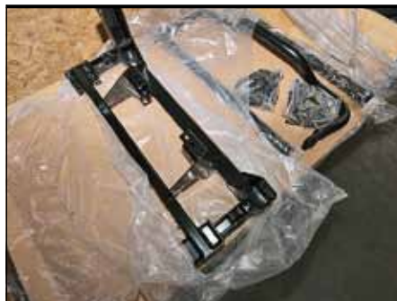
Эта конструкция служит верхней опорой баллонам и реактивным штангам
