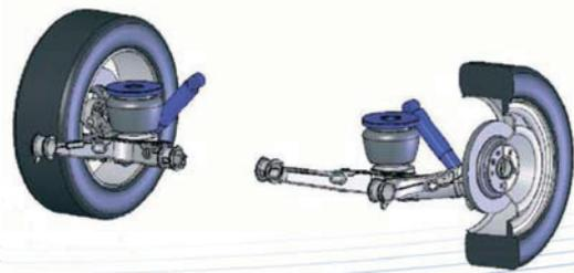
***с пневмоподвеской задней оси VB-FullAir 2C***
